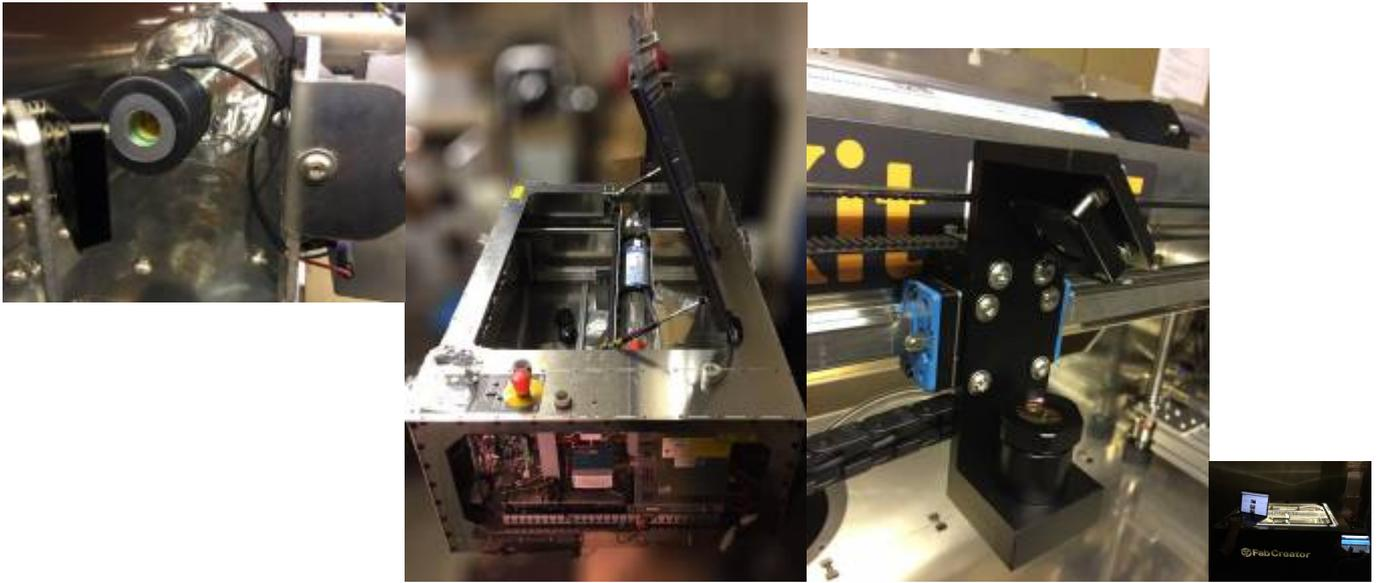
Weiter ging es mit dem einbau des Lasers und Fertigstellung der Verkabelung
