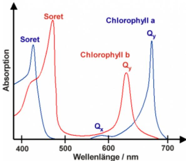
Wie im Bild zu sehen ist, ist der Bereich von 500-600nm nicht Verwertbar, dafür jedoch unterhalb von 500nm der Blaue Bereich sowie der UV Bereich unterhalb von 400nm. Oberhalb von 600nm ist der Rote Bereich der bis ca. 680nm nutzbar ist.
