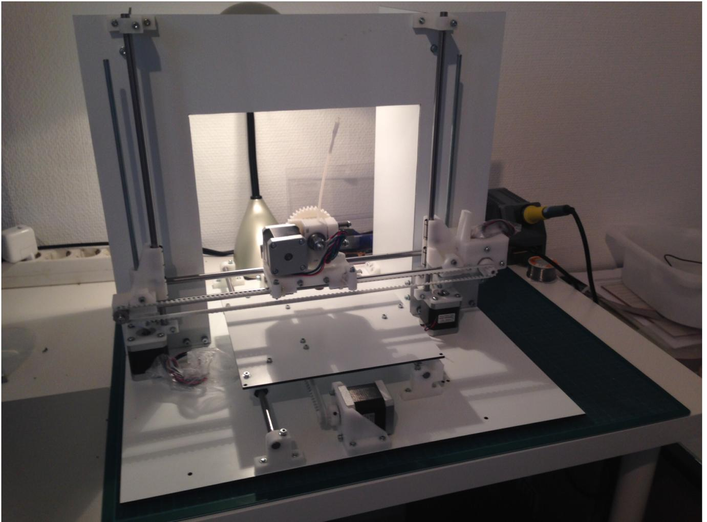
Überflüssige Kabel am Schaltnetzteil habe ich auf den Hauptstrang reduziert. Alle Kabel der Hauptplatte laufen in Kabelkanälen und dem Drucker, welche parallel dazu auch die „Füße“ mit bilden.
