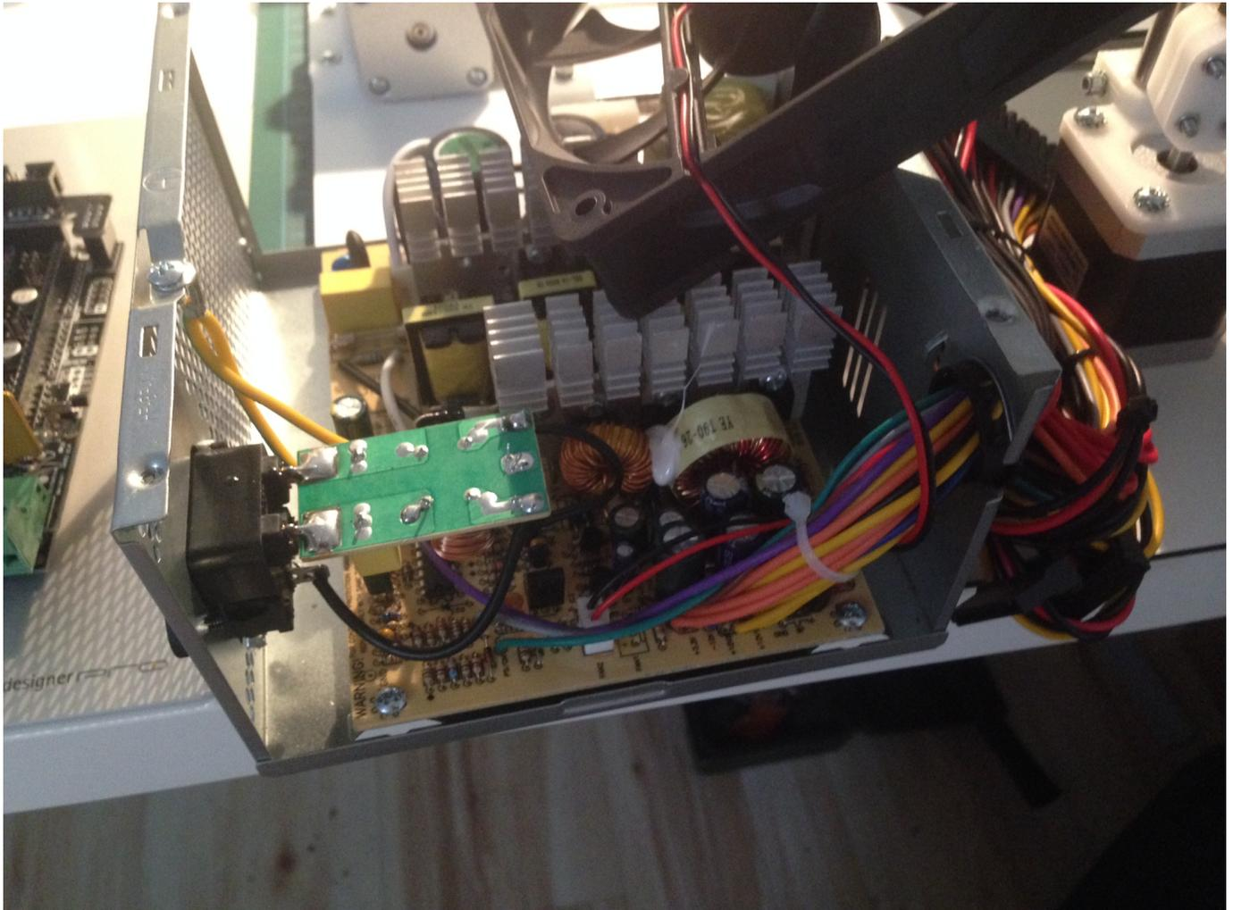
Probelauf der Technik, Temperaturgrenzen liegen bei 255 bzw 115 Grad am Extruder und Heizbrett. Für ABS ok, wenn auch knapp am Limit. Das Zuleitungskabel am Extruder musste ich leider später noch ersetzen. (Kabelbrand) Kritikpunkt am Mendelprinzip, schlecht berechnete Querschnitte.
