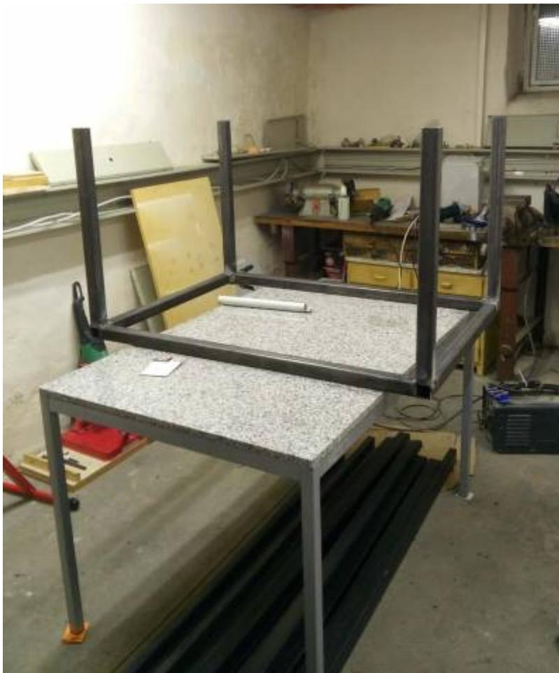
Um eine ebene Fläche zu erhalten, wird der Rahmen kopfüber auf der polierten Granitplatte zusammengebaut.
