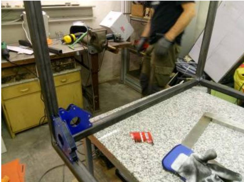
Der Rahmen des Untergestell wird wie die Maschine aus Vierkantstahlrohr zusammengefügt.
