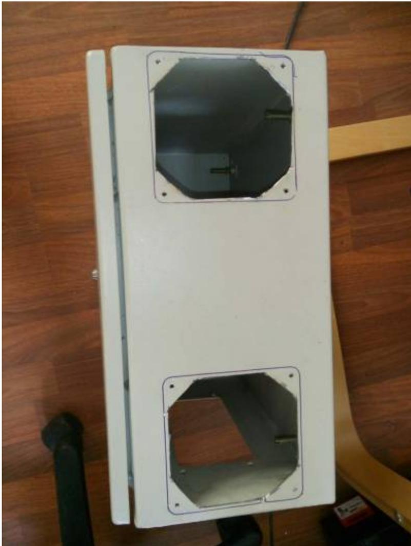
Der Schaltschrank bekommt Lüfter um die Temperatur im inneren erträglich zu halten. Bei 50°C Umgebungstemperatur schaltet sich der Frequenzumrichter mit Fehlermeldung ab, was unbedingt verhindert werden muss.
