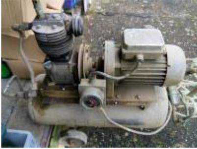
Es handelt sich um einen Kolbenkompressor mit Kraftstrommotor. Das Druckluftaggregat ist in der DDR für Fahrzeuge wie Traktoren und den LKW (Bremsanlage) eingesetzt worden, und auch von mehreren Betrieben mit Elektromotoren zu Werkstattkompressoren zusammengebaut worden.
