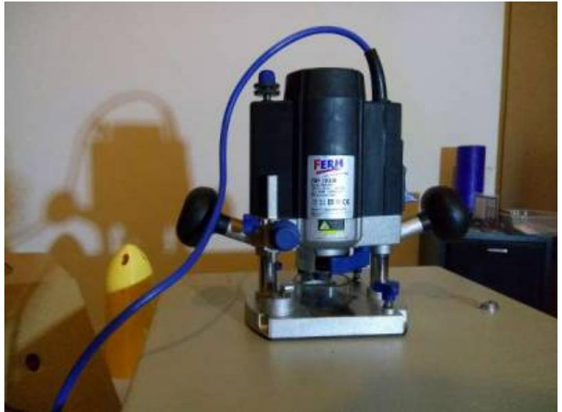
Die Oberfräse ist mit einer selbstgebauten Vorrichtung zum Fräsen von Kreisen oder Kreisbögen ausgestattet. Diese ist bitte dauerhaft am Gerät zu belassen und für andere Arbeiten die Oarkside Oberfräse zu verwenden.
