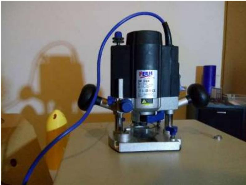
Insbesondere beim Bearbeiten von Hartholz ist es sehr wichtig, in der richtigen Bearbeitungsrichtung (im Gegenlauf) vorzugehen oder mit kleinen Zustellungen zu arbeiten, da sich in der falschen Richtung der Fräser ins Holz zieht und sowohl die Fräse als auch das Werkzeug durch Blockieren und starkes Rupfen beschädigt werden können.
