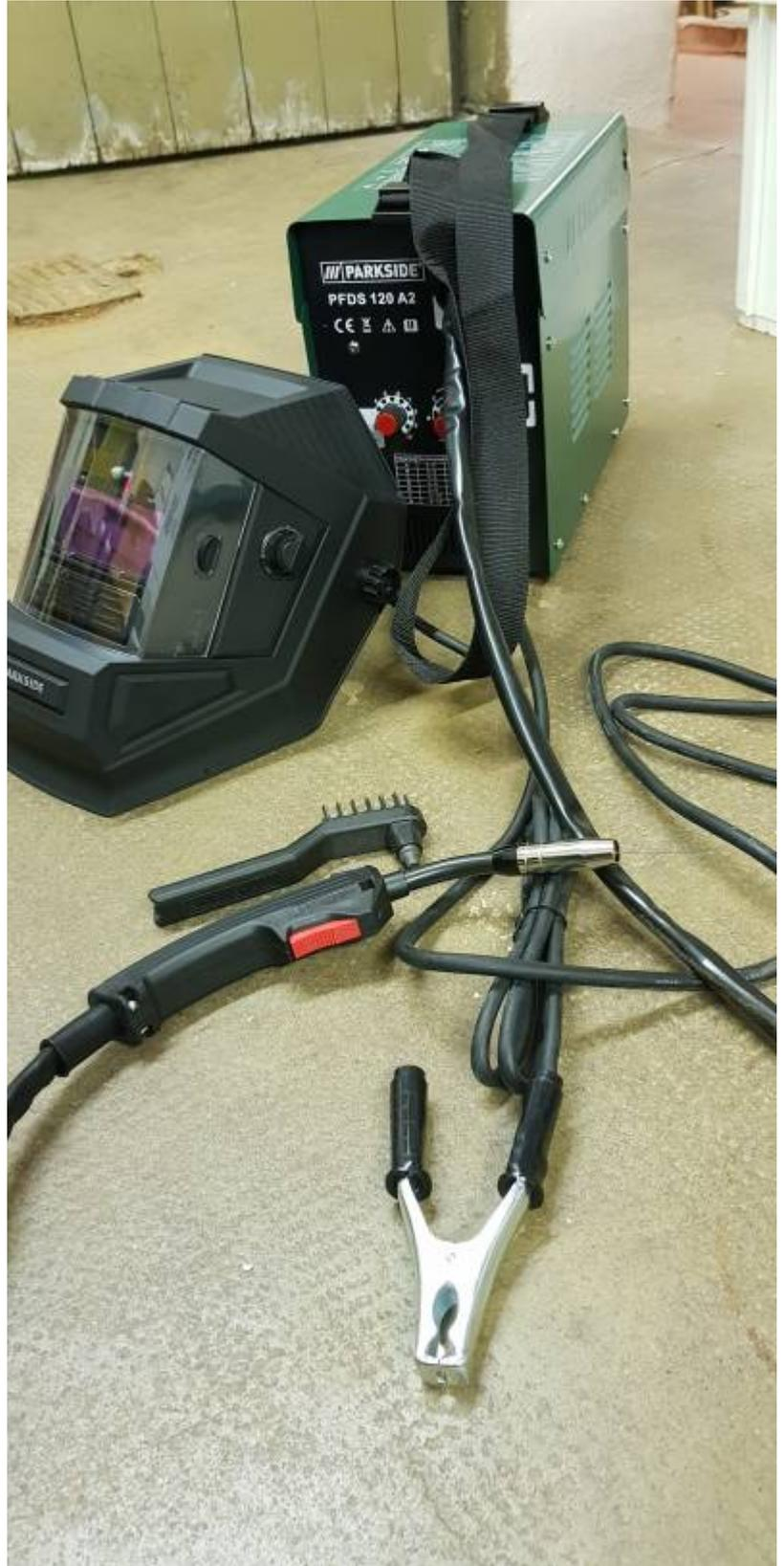
Seit Oktober 2021 haben wir ein Fülldrahtschweißgerät PFDS 120 A2 von Parkside mit Fülldrahtdurchmessern 0,6 / 0,8 / 0,9 / 1,0 mm. Das Schweißgerät kann bis zu 120 A liefern. Auch die Vortriebsgeschwindigkeit für den Draht ist einstellbar. Es gibt für die 4 Drahtdurchmesser entsprechende Schweißdüsen im Gerät. Zubehör ist eine Drahtbürste mit Schlackenhammer. Es gibt außerdem einen Automatik-Schweißhelm mit automatischer Schattierungskontrolle.
