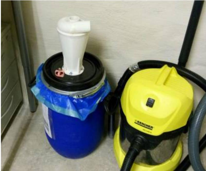
Der Staubsauger wird oben in der Mitte angesteckt (dazu befindet sich ein entsprechend passender Konus im Bauteil).
