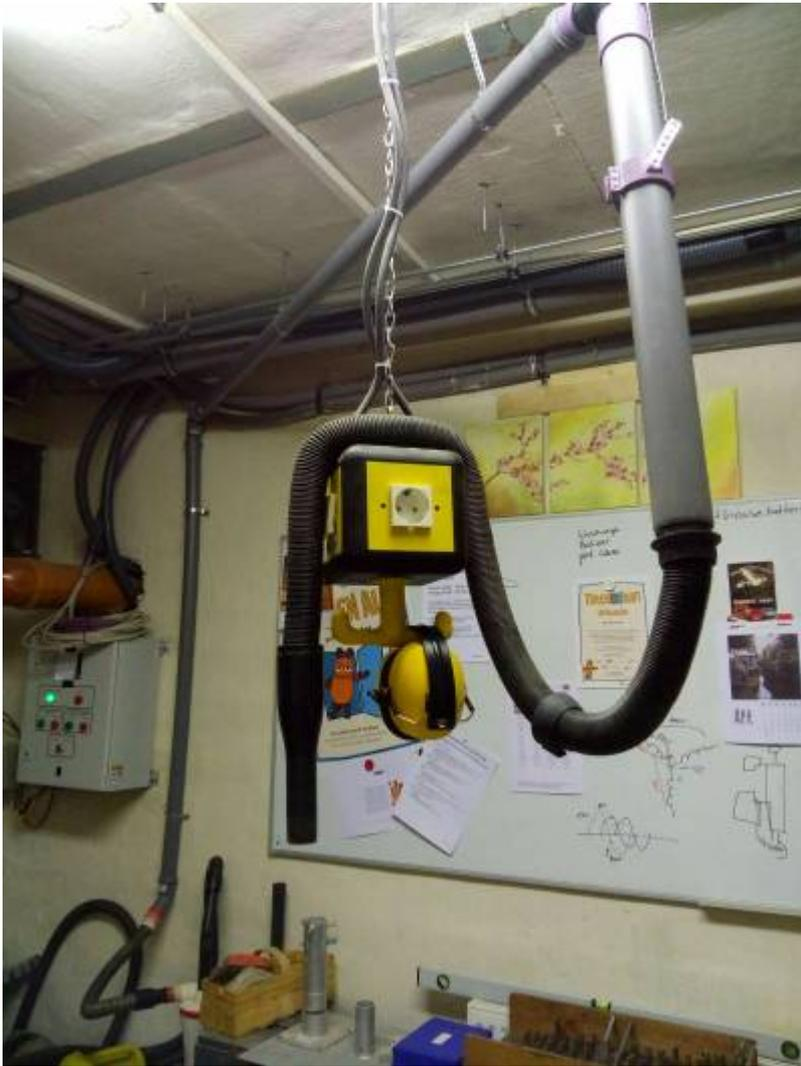
Das herabhängene Rohrstück ist über ein kurzes Schlauchstück flexibel befestigt und folgt den Bewegungen des Saugschlauches. Der Saugschlauch ist ein Teleskopschlauch und erlaubt viel Freiheit beim Arbeiten. So kann der Staub von elektrischen Handwerkzeugen gleich abgesaugt werden, was die Luftqualität in unserer Werkstatt verbessert.
