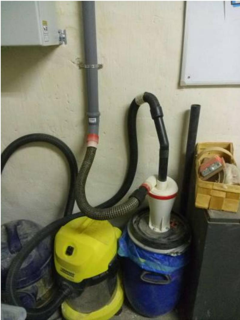
Der Anschluß an den Abscheider wurde mit einem gebrauchten Teilstück eines alten Saugschauches gemacht und per 3D-gedrucktem Adapter angeschlossen.
