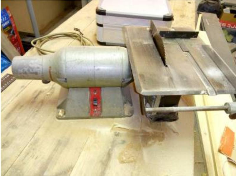
Aufgebaut ist sie mit einem 450W 220V 3000U\*min-1 Motor für Doppelschleifmaschinen („Bench Grinder“), an den Zubehörteile wie die Kreissäge „Typ KS“ oder ein Abrichthobel „Typ EH125“ (125mm Messerbreite) angebaut werden können.
