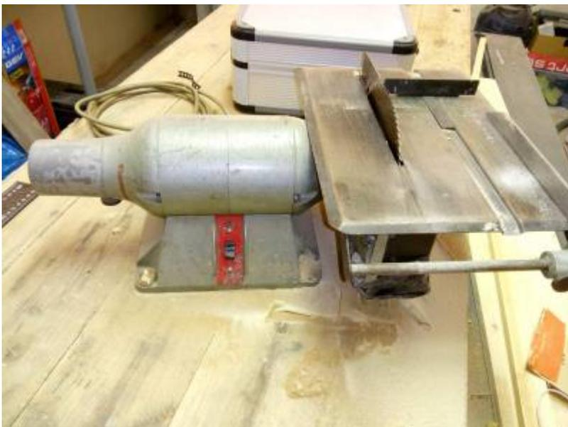
Aufgebaut ist sie mit einem 450W 220V 3000U\*min-1 Motor für Doppelschleifmaschinen („Bench Grinder“), an den Zubehörteile wie die Kreissäge „Typ KS“ oder ein Abrichtobel „Typ EH125“ (125mm Messerbreite) angebaut werden können.
