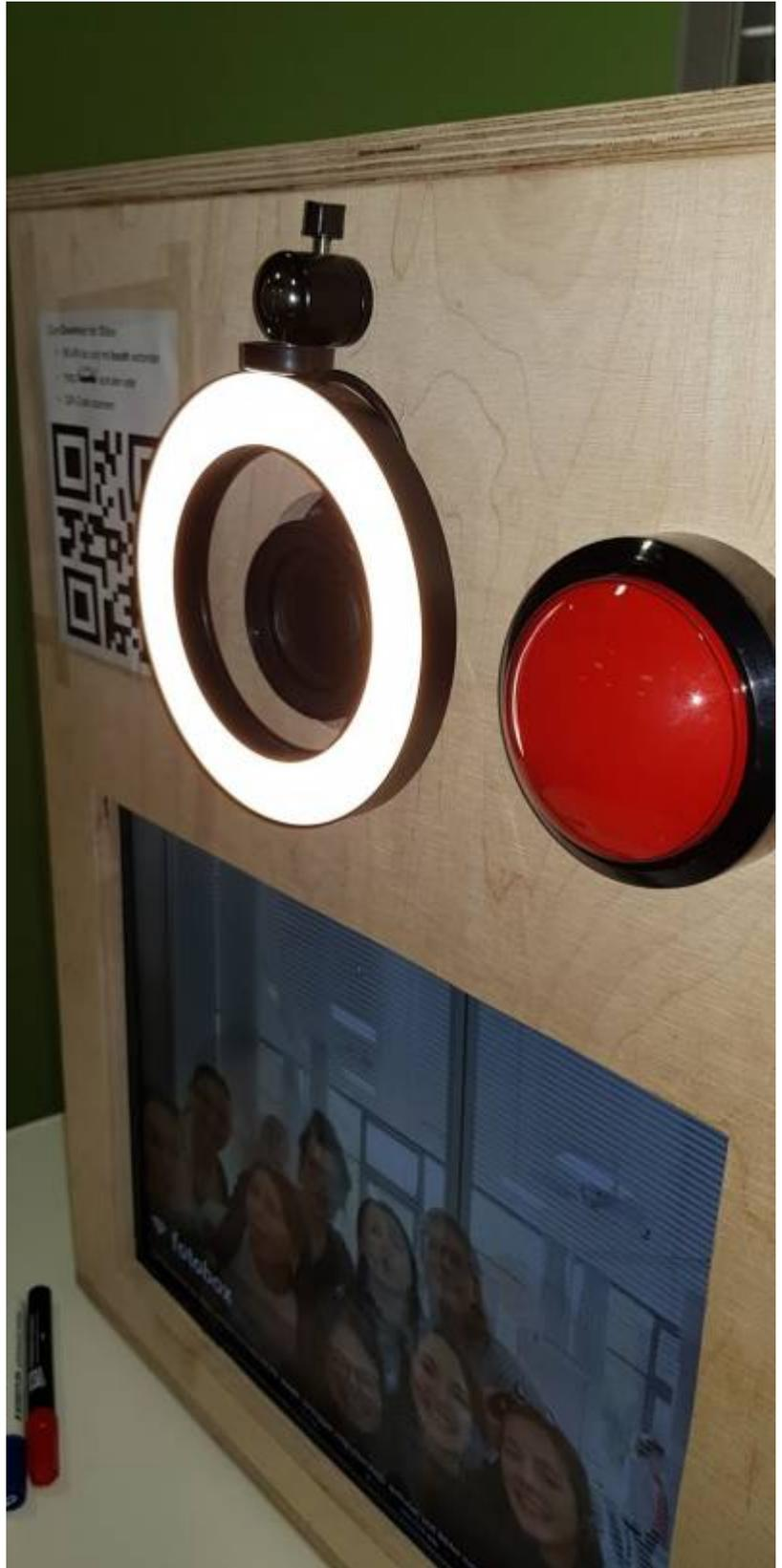
Die Fotobox besteht aus einem Holzkasten mit einem Display, z.B. einem LCD eines Laptops. Durch eine Öffnung ist das Objektiv der Kamera, einer alten Spiegelreflex zu sehen. Martin hat an seiner Box einen großen „Buzzer“ angebracht, der den Selbstauslöser startet. Für eine bessere Beleuchtung befindet sich um das Objektiv ein Belichtungsring. Als Bonus-Feature kann die Bildergalerie direkt per WLAN aufgerufen werden.
