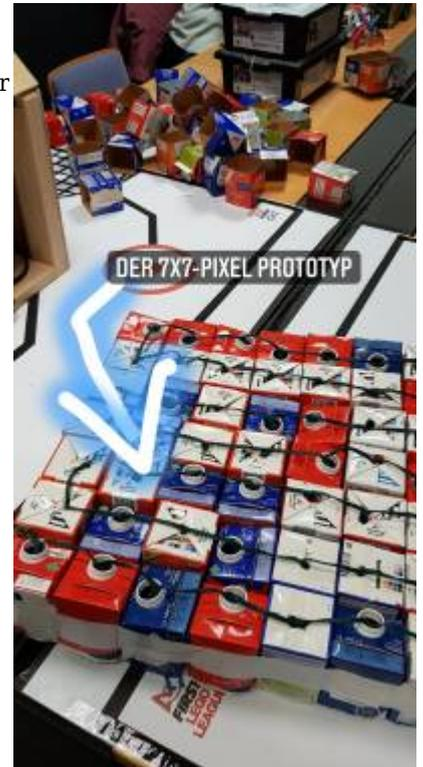
Die LEDs werden nun auf der Rückseite in die Kartons gesteckt. Die Verkabelung sollte vorab auf einem Kästchenpapier geplant werden (Reihe, Schlange, Mäander). Die LEDs könnten zur besseren Übersicht mit kleinen Fähnchen durchnummeriert werden. Der Controller wird mit der Lichterkette verbunden: 5V, GND und ein Digital-Ausgang (z.B. D5).
